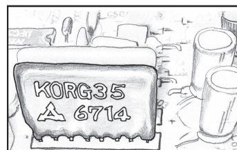
Figura 6: Placa de circuito del generador de sonido PS-3300, en la que se montó el KORG35
