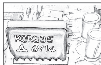
（図6）KORG35を実装したPS-3300の音源基板
